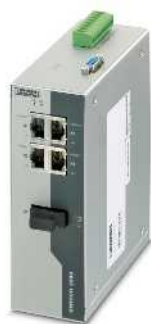
4 puertos RJ45 y 1 puerto de fibra óptica (multimodo)
