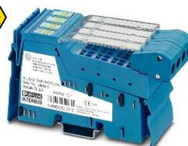
4 entradas de temperatura seleccionables, RTD o TC
