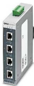
4 puertos RJ45 y 1 puerto de fibra óptica
