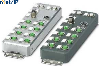
8 entradas digitales y 8 salidas digitales
