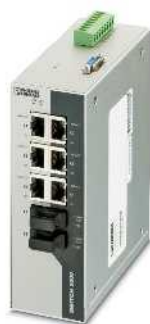
6 puertos RJ45 y 2 puertos de fibra óptica (multimodo)
