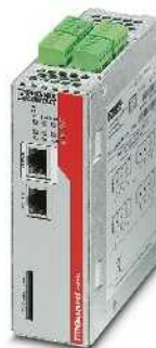
Router con cortafuegos inteligente y VPN
