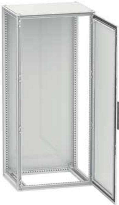
Sistema de armario combinable concebido para armar conjuntos de armarios formado por 4 montantes verticales de acero galvanizado y 2 marcos superior e inferior soldados y atornillados a los montantes verticales que confieren al conjunto gran versatilidad y robustez. Fondo y laterales formados por paneles metálicos de 1,5 mm de espesor, puertas de 2 mm reforzadas con o sin cristal y una amplia gama de accesorios para realizar los montajes requeridos.
